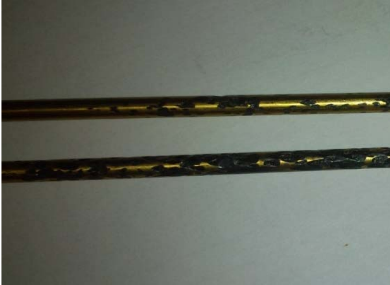
普通结构磨损的阀针 一个星期的时间
