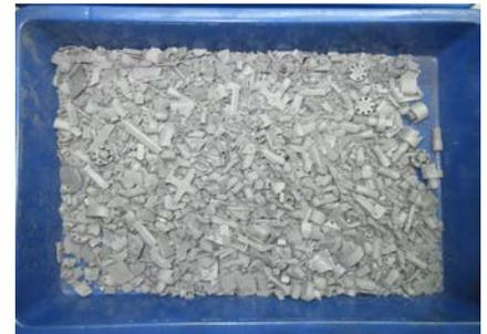
由于在转炉或导入烧结炉的工序中，约**0.5~1%**左右的制程不良出现，对于产品高度大于15mm，底面接触面积 $\leq 30\text{mm}^2$ ，制程不良 $\geq 1\%$ ，该如何改善**0.5~1%**制程不良。
