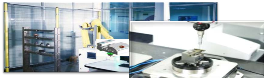
机外装夹工件校正
