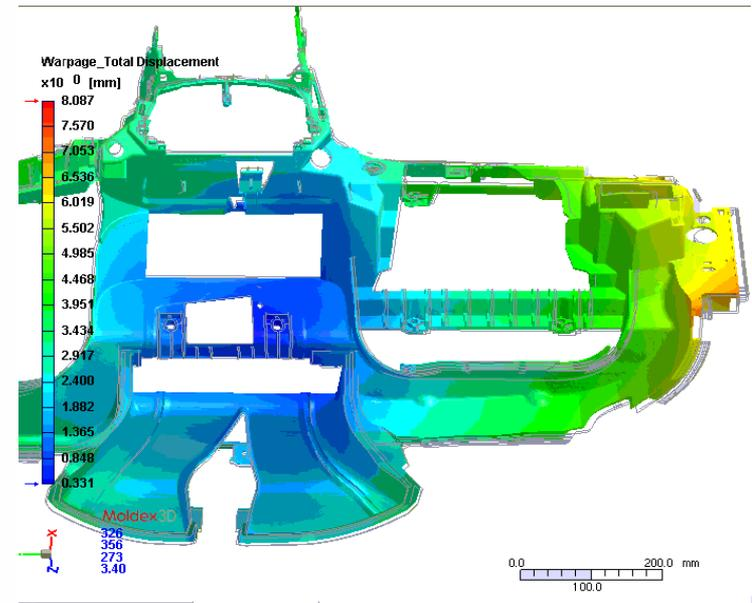
微细发泡成型(MuCell®)产品，8.08毫米
