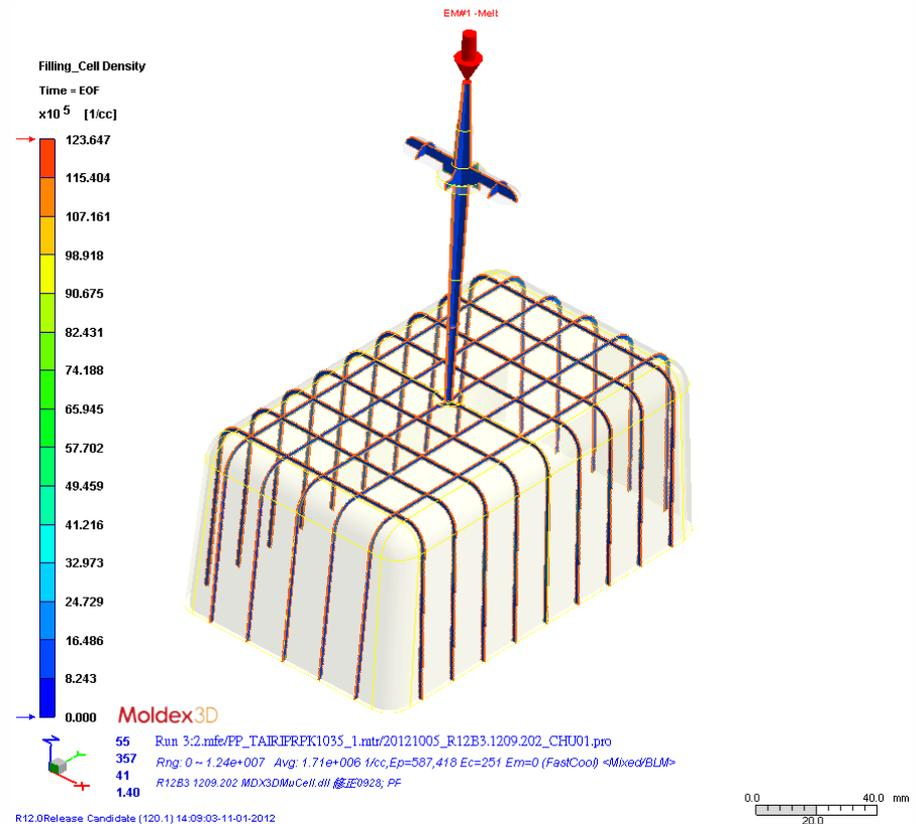
透过剖面功能，显示充填/保压结束的中央气泡大小与气泡密度结果
