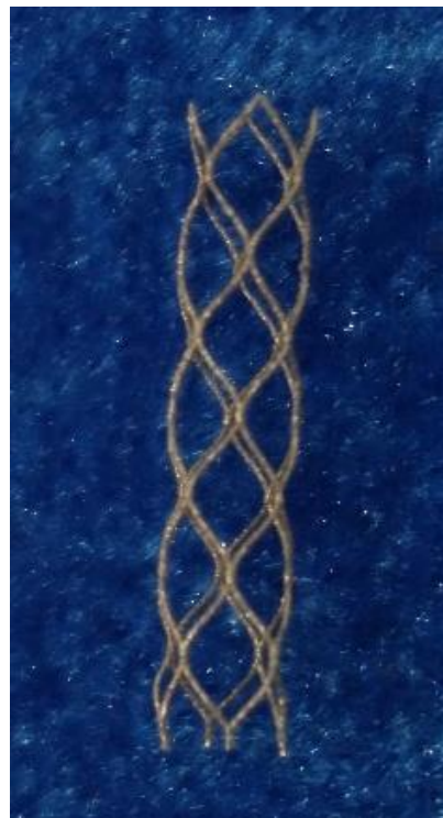
钛合金植入体 SLM直接成形丝径仅为80 \mu m
