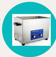
利用超声波的震动，目前市面采用的超声波振子为28KHZ，力度大，噪音大，需采用加热清洗时间长，对精密保养无意义，主要用来清洗产品及简单模具日常保养。
