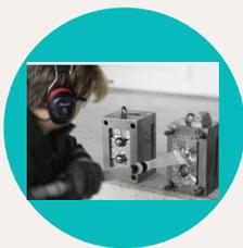
不用拆模具，扫射清洗需要佩戴防护面具及手套，噪音大；只能针对平面清洗，效果一般，对孔位，死角无法清洗彻底。干冰用于发泡模具清洗为最佳。
