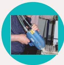
主要用于橡胶模具，清洗橡胶残留物及硫化物，对模具表面有损伤。不建议塑胶产品模具使用此类清洗方式。
