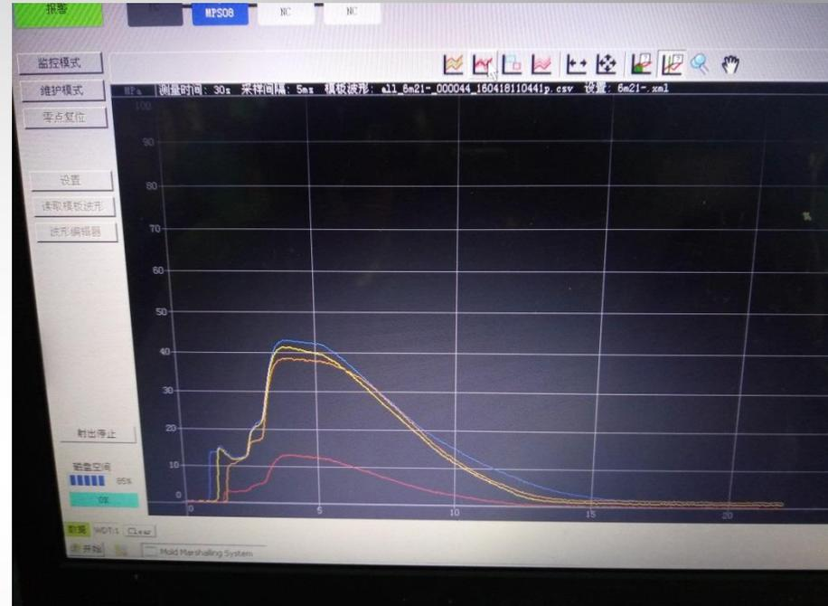
压力曲线起点不一样,判断热流道的热嘴温度不均造成.调整热嘴温度起点一致.压力偏低,判断这一穴流道不平衡.
