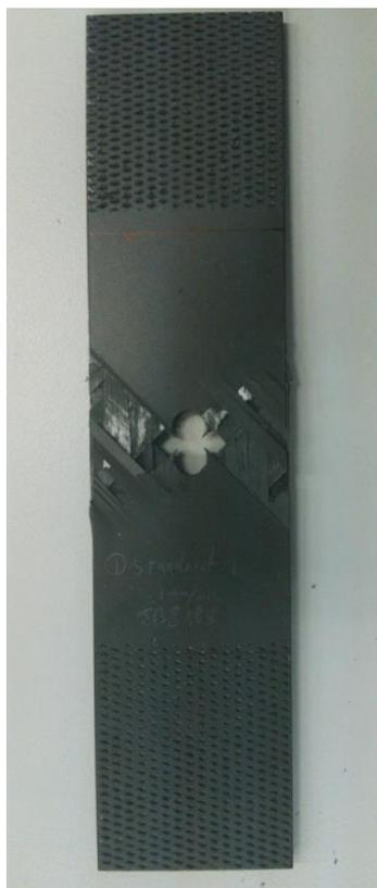
在CFRP多层板的中间打孔
