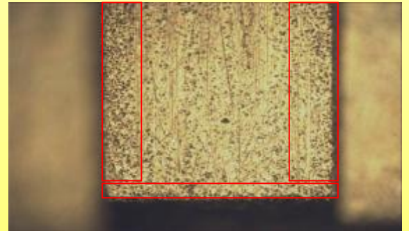
□ 難以用研磨石研磨的部分 放電加工面的研磨殘留處
