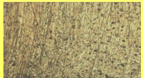
□ 難以用研磨石研磨的部分 放電加工面的研磨殘留處
