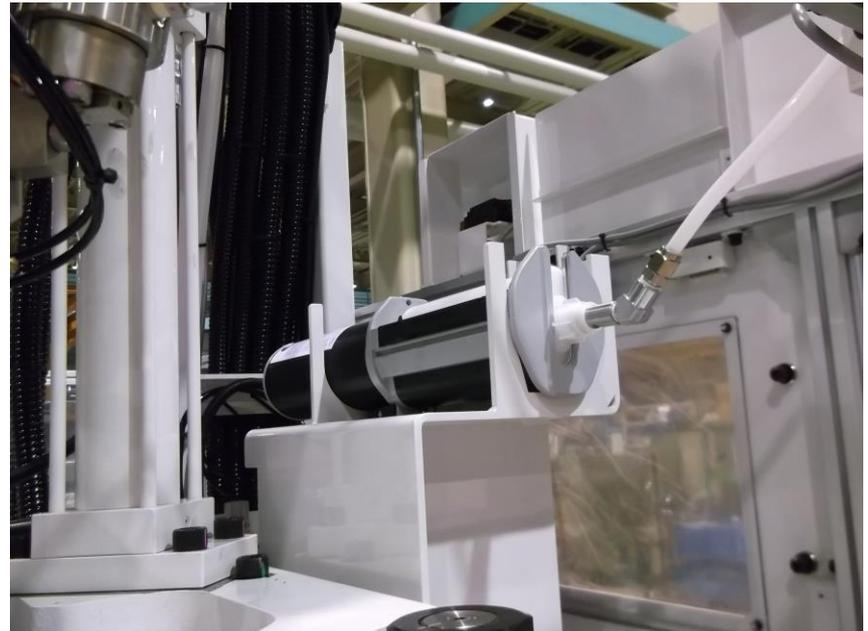
一液式样的简易型材料供给装置
