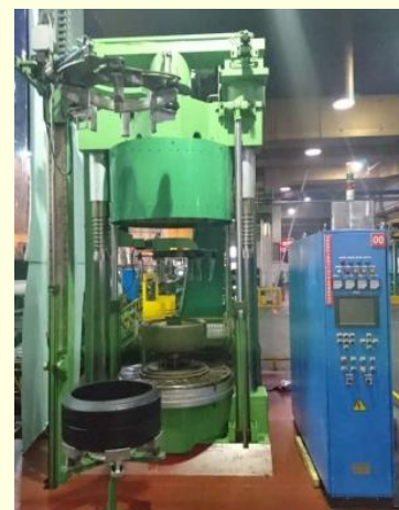
全电磁感应加热直压精密定型轮胎硫化机 (创新3)
