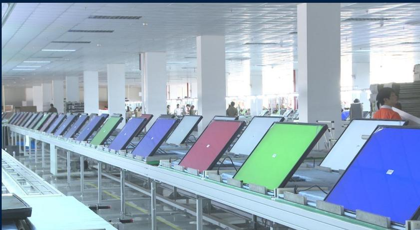
依托毅昌在广州，江苏青岛等园区配备的22条模组线及11条整机线体，为客户提供拥有全部知识产权的从11寸到86寸的D-led,E-led及商用的直面或曲面模组和整机的生产。具备年产1000万台模组和600万台电视整机的能力。
