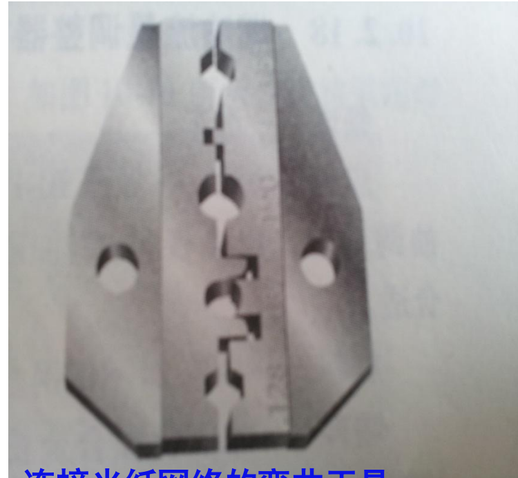
连接光纤网络的弯曲工具 材料： 4140 (Fe-1Cr-0.4C)
