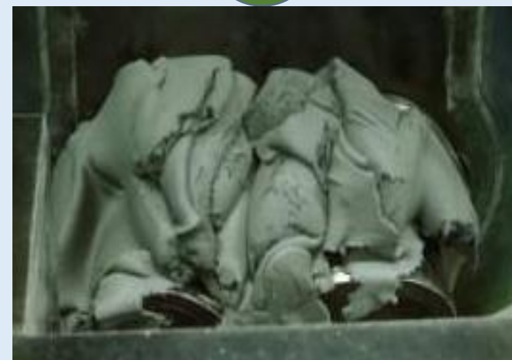
正确混炼得到的喂料团块 Feedstock dough
