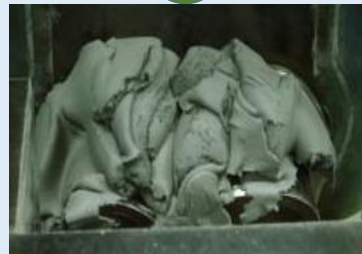
正確混煉得到的喂料團塊 Feedstock dough
