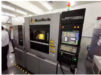
圖 11：在最佳運行環境中使用金屬 3D 列印成型機“LPM325”
