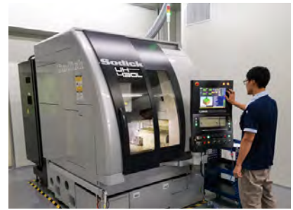
圖 12：為實現更高精度、以及精密加工而引進的高速銑削中心“UH430L”
