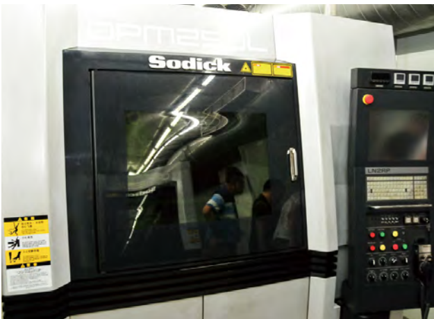
圖 3：2017 年，公司自日本引進兼具金屬積層製造與切削加工功能的“OPM250L”金屬 3D 列印成型機
