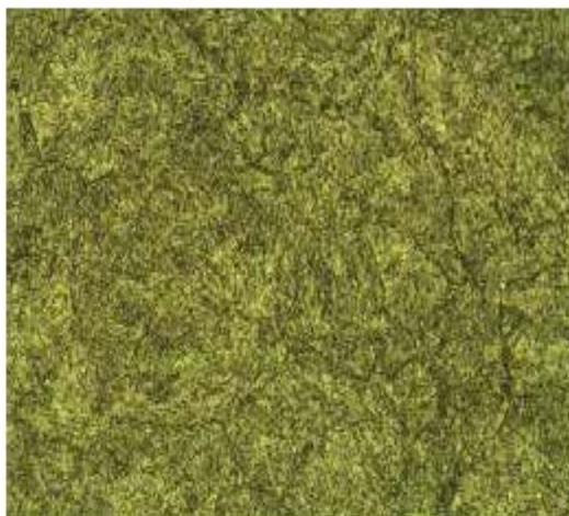
Pig 9 金相組織圖(Microstructure)500 倍(腐蝕後)
