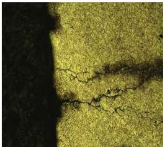
Pig 7 金相組織圖(Microstructure) 200 倍(腐蝕後)
